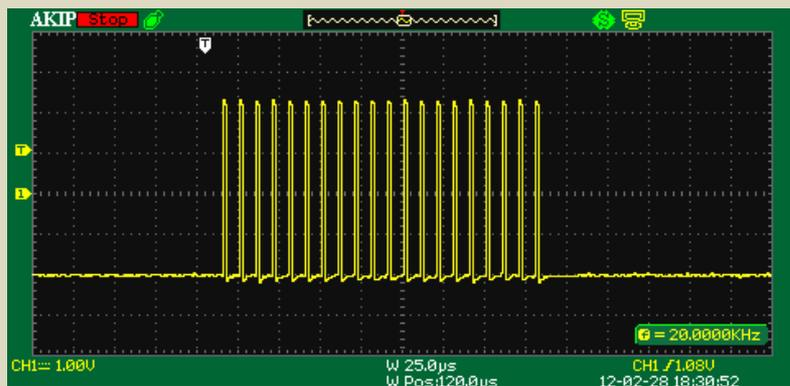
Нажатие всего одной кнопки **Время/деление** – активирует режим цифровой растяжки (zoom) для детального анализа осциллограммы и проникновения в структуру исследуемого сигнала.
