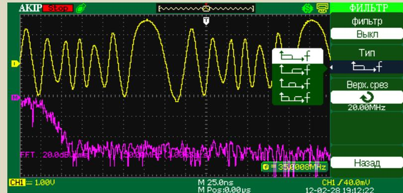
Интерполяция  $\text{Sinx}/(x)$  позволяет увеличить достоверность отображения сигнала при частотах сигнала сопоставимых с верхней частотой ПП.
